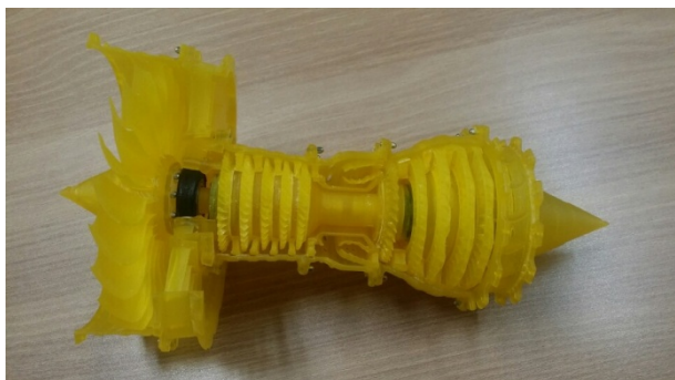
飛行機エンジン模型 パーツ毎に造形し組み立ても可能
